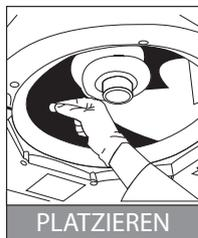
StayClean™ Mini Tablets neben den Wärmetauscher am höchsten Ende der Kondensatwanne platzieren, damit die gesamte Wanne von der Behandlung profitiert. Bei der ersten Anwendung oder wenn Wanne und Abfluss stark verschmutzt sind, empfiehlt es sich, die vorgeschlagene Dosierung zu verdoppeln.
